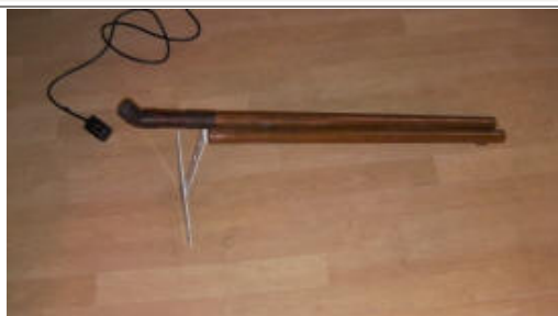
8. Tubo di collegamento dello scambiatore con il ventilatore e tubo uscita aria calda
