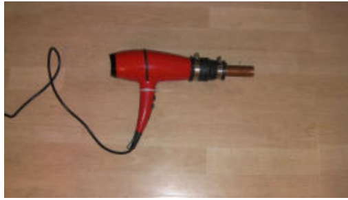
11. Ventilatore con tronchetto di connessione con il tubo di collegamento con lo scambiatore
