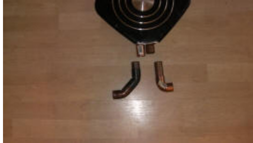
14. Tronchetto di collegamento dello scambiatore con il ventilatore e tronchetto di uscita dell'aria calda.
