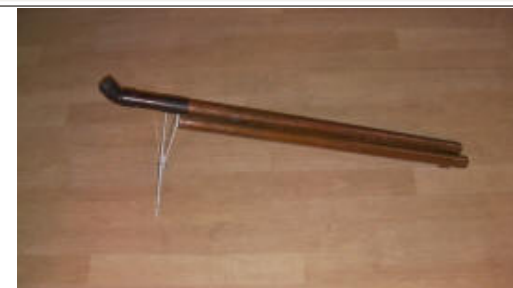
9. Tubo di collegamento dello scambiatore con il ventilatore e tubo uscita aria calda
