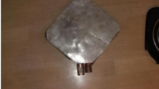
10. Tubo di collegamento delle scambiatore con il ventilatore e tubo uscita aria calda
