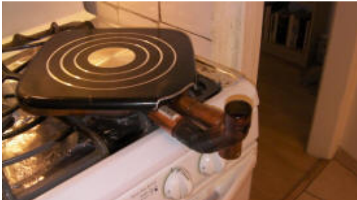
16 Il generatore di aria calda per cucina a gas in posizione di lavoro senza il solo ventilatore
