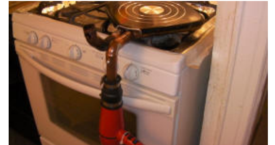
18 Il generatore di aria calda per cucina a gas completo ed in posizione di lavoro.
